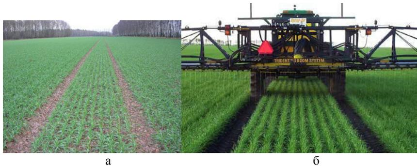
Рис. 1. Технологическая колея: а) общий вид; б) проход агрегата по технологической колее
