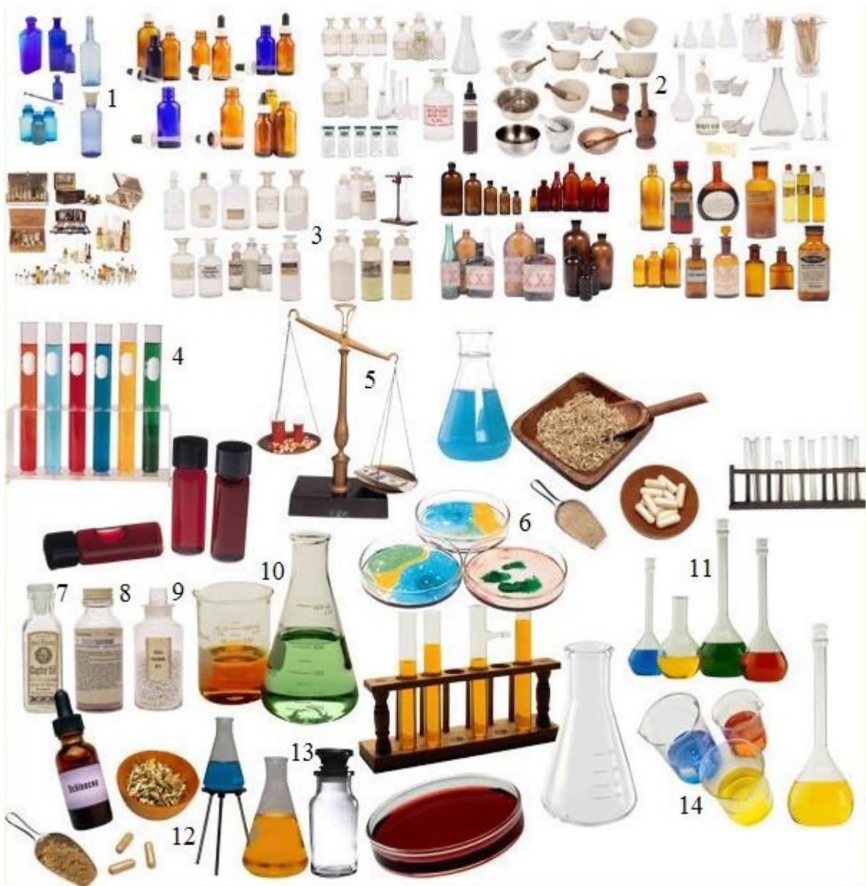
Рисунок 35 – Лабораторная посуда и вспомогательное оборудование: 1 – штангласы; 2 – ступки; 3 – стеклянные банки; 4 – пробирки; 5 – механические весы; 6 – чашка Петри; 7 – полимерные пробки; 8 – корковые пробки; 9 – банки с притертыми стеклянными пробками; 10 – колба Эрленмейера; 11 – мерная колба; 12 – тренога; 13 – резиновые пробки; 14 – мерный стакан.
