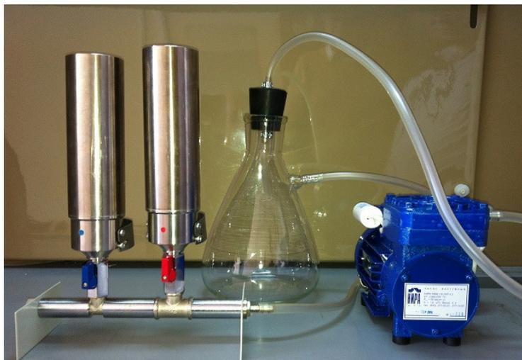
Рисунок 13 – Прибор вакуумного фильтрования ПВФ (<http://analytic-lab.ru>)
