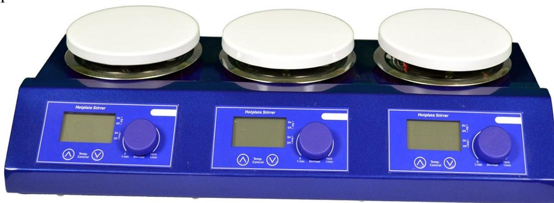
Рисунок 32 – Магнитная мешалка с подогревом
