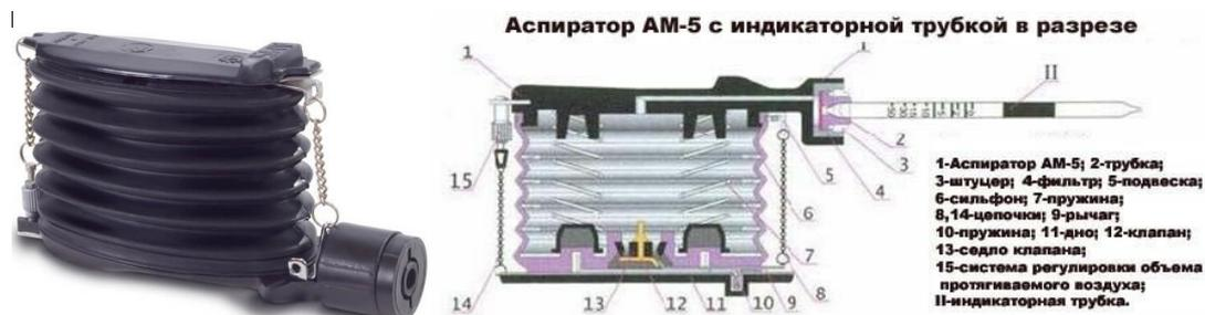
Рисунок 14 – Сильфонный аспиратор АМ-5Е / АМ-5 / АМ-5М (внешний вид и в разрезе) (<http://magazinlab.ru>)
