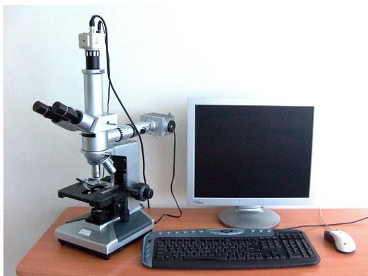
Рисунок 19 – Микроскоп поляризационный лабораторный тринокулярный «BinaLogic 6XB-PC»
