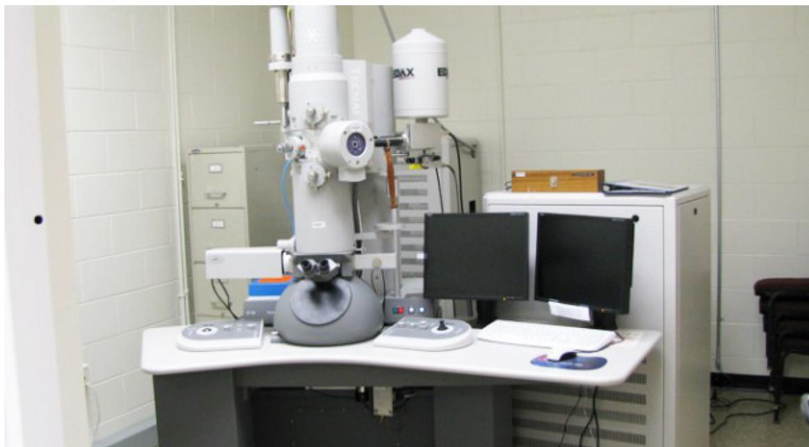
Рисунок 25 – Трансмиссионный электронный микроскоп (<http://www.extremetech.com>)
